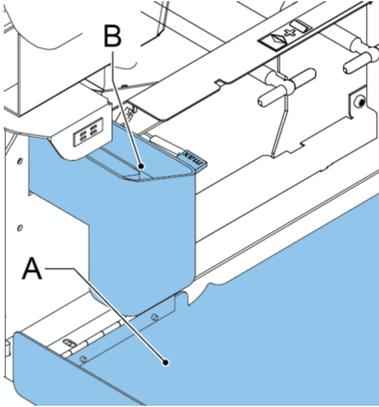
2. Den Verschlußflüssigkeitstank **B** aus dem System entfernen.
