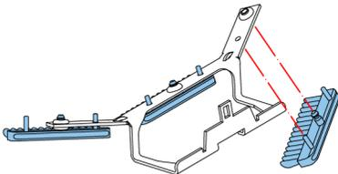
4. Die Bürsten austauschen. Stellen Sie sicher, dass die Stifte auf den Bürsten in den entsprechenden Löchern im Bürstenhalter einrasten.
