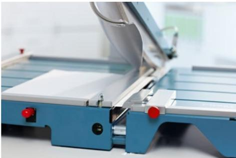
Vordertisch mit magnetischer Steckverbindung für mehr Arbeitsfläche
