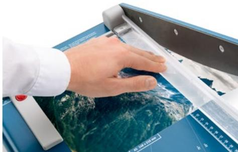
Dahle Schneidemaschinen 534 - manuelle Pressung mit integriertem Fingerschutz zur sicheren Fixierung des Schnittgutes
