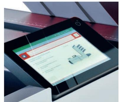
► Über den neuen 7" großen Farb-Touchscreen und eine intuitiv angelegte Navigation wird der Benutzer durch leicht verständliche Anweisungen und Symbole bei Einstellung und Abruf der Jobs geführt und unterstützt.
