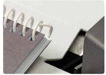
Perfektes Abschneiden und Umbiegen der Plastikspiralenden durch die integrierte Spiralabschneide- und Umbiegevorrichtung. Für Metallspiralen wird eine SC-Zange benötigt.
