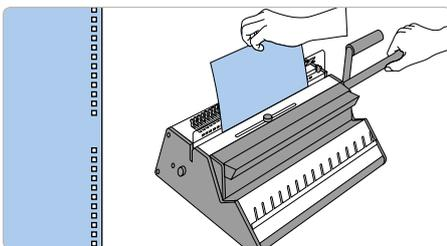
Arbeitsablauf am Beispiel der RENZ SRW 360 (oder einer anderen RENZ Stanzmaschine mit QSA-Technologie): Die 3 Stanzstempel in der Mitte des Kalenders ausschalten und diesen wie üblich stanzen. Den Kalender mit den 3 ungestanzten Mittellöchern aus der Maschine entfernen.
