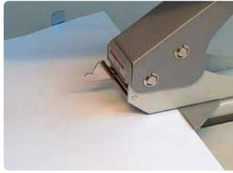
Kalender in den Stanzschacht einlegen und Hebel nach unten drücken.
