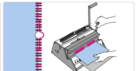
Der horizontale Schließmechanismus der RENZ SRW 360 ermöglicht ein einfaches Binden des Kalenders zusammen mit einem Kalenderaufhänger.
