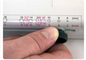
Bindet bis zu 480 Blatt. Die DurchmesserEinstellung garantiert ein schnelles Öffnen, sowie einfaches Schließen des Plastikbinde-
