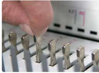
Die QSA-Technologie (Quick Size Adjustment) erlaubt das sekundschnelle Ausschalten der Stanztempel, wodurch Papierformate einfach und schnell gewechselt werden können.<sup>(1)</sup>
